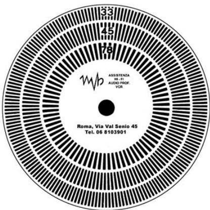
Se lo stroboscopio si illumina una volta al secondo, e il riferimento è visto fermo, la ruota ha compiuto almeno un giro completo, ma possono essere anche 2, 3, ecc. ovvero la velocità di rotazione può essere un multiplo intero della velocità di illuminazione.
